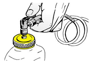
Conexión aparato expurgación-frenos y cubeta mediante enganche rápido
