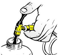
Antes de la expurgación es importante realizar el llenado de la cubeta de aceite frenos a través del enganche rápido de los expurga-frenos
