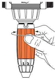
Le réglage du dosage s'effectue en faisant correspondre l'œillet de la bague de réglage à la graduation souhaitée sur la règlette. La quantité de produit injectée est proportionnelle à la quantité d'eau qui entre dans le Dosatron :
