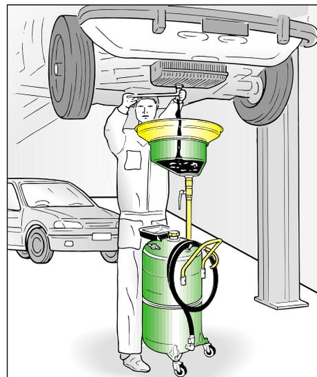
**Recuperadores aceite con depósito con carro: práctico y funcional** adecuados para la recuperación, por caída, del aceite motor, cambio y diferencial de todos los autovehículos colocados en el puente elevador o foso. La **bandeja** de capacidad 13 litros es montada lateralmente, permite la utilización aún en situaciones a veces difíciles. Es además regulable en altura y dotada de articulación giratoria para ser posicionada mejor.
