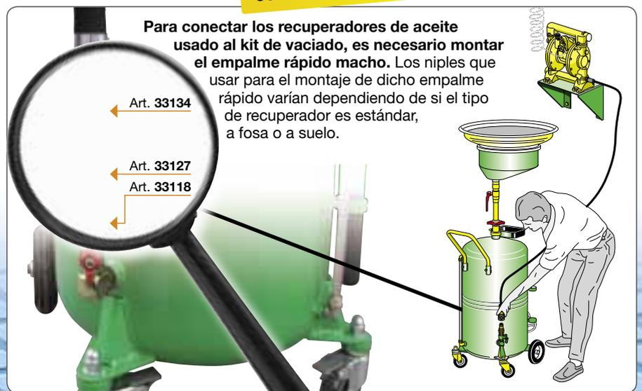
Para conectar los recuperadores de aceite usado al kit de vaciado, es necesario montar el empalme rápido macho. Los nipples que usar para el montaje de dicho empalme rápido varían dependiendo de si el tipo de recuperador es estándar, a fosa o a suelo.
